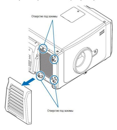
Потяните верхнюю часть фильтра на себя и приподнимите его. Извлеките старый фильтр.
