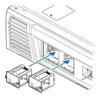
Закрутите по 2 винта на каждой лампе. Зафиксируйте ручки в защёлки.
