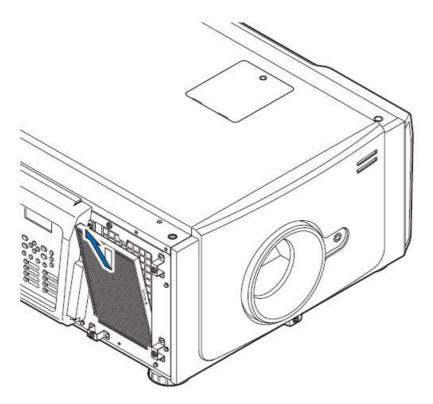
Вставьте новый фильтр нижним краем внутрь. Стрелка, указывающая направление потока воздуха, должна показывать внутрь проектора. Прижмите верхнюю сторону фильтра.
