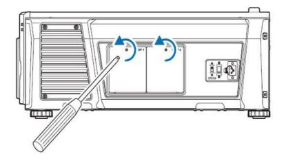
Возьмитесь за штырь винта и потяните его вверх и на себя, чтобы снять крышку лампы. Снимите обе крышки.
