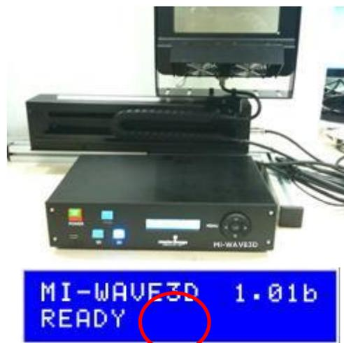
Изображение 15. Автоматическое включение питания и индикация на дисплее
