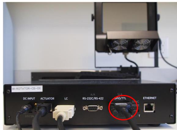
Изображение 13. Подключение кабеля GPIO
