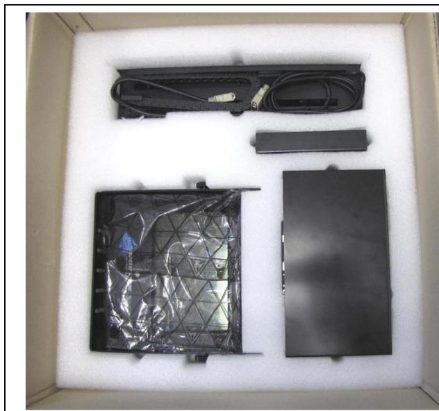
Средний слой: LCPM, привод, вентиляторы и пульт управления
