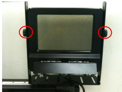
Изображение 9. Шурупы для настройки высоты и угла наклона
